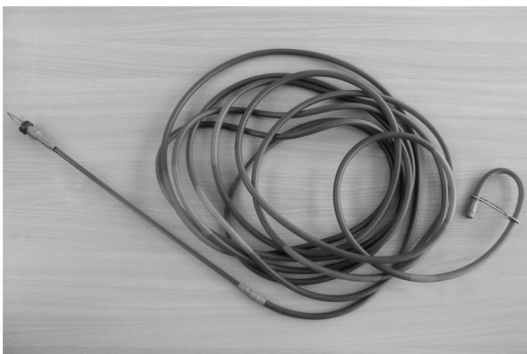
Obr. 2. Vodní barometr jako celek
